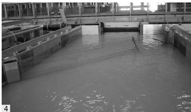
Abbildung 3.3 Versuch unter Zugabe von Ästen: (1) Anfangszustand (gespannte Seile), (2) Ablegen der Seile, (3) Wiederanspannung der Seile, (4) Endzustand nach Mobilisierung der verlegten Fläche
