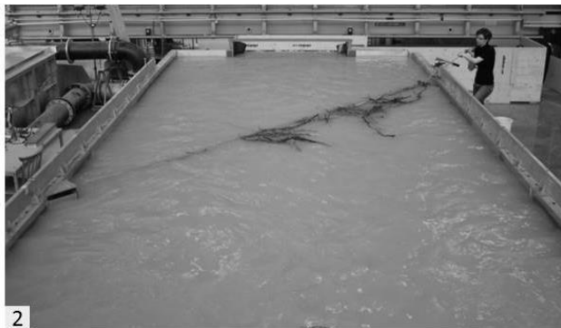
Abbildung 3.2 Versuch unter Zugabe von Laub: (1) Anfangszustand (gespannte Seile), (2) Ablegen der Seile, (3) Wiederanspannung der Seile, (4) Endzustand nach Mobilisierung der verlegten Fläche
