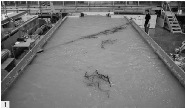
Abbildung 3.2 Versuch unter Zugabe von Laub: (1) Anfangszustand (gespannte Seile), (2) Ablegen der Seile, (3) Wiederanspannung der Seile, (4) Endzustand nach Mobilisierung der verlegten Fläche
