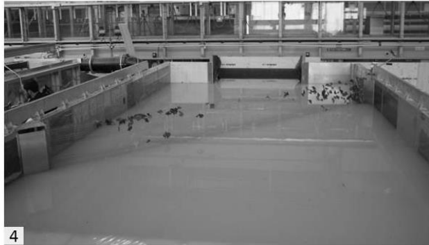
Abbildung 3.2 Versuch unter Zugabe von Laub: (1) Anfangszustand (gespannte Seile), (2) Ablegen der Seile, (3) Wiederanspannung der Seile, (4) Endzustand nach Mobilisierung der verlegten Fläche
